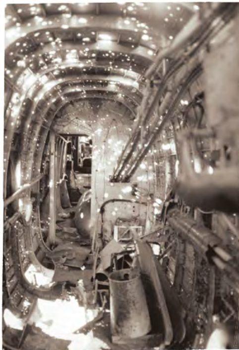
Dégâts à l'intérieur d'un bombardier anglais Handley Page Halifax causés par les éclats d'obus des canons de la Flak, la défense anti-aérienne allemande.
